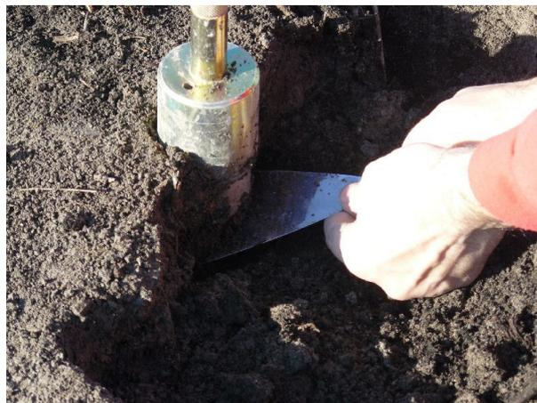
*Photo 12 : Prélèvements d'échantillons de sol*
