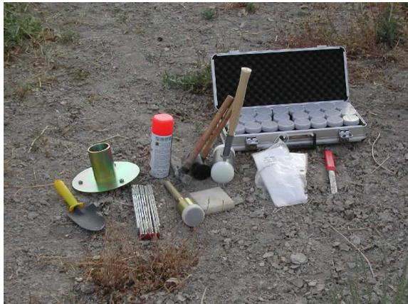
Photo 3 : Equipement de prise d'échantillons de sol inaltérés
