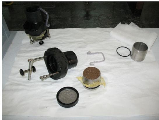
*Photo 9 : Matériel utilisé pour le perméamètre*
