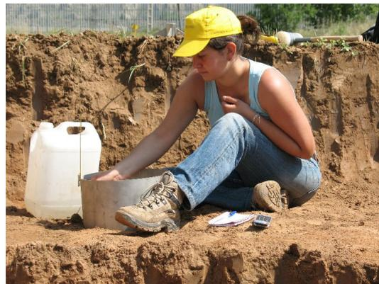
*Photos 4 & 5 : Mise en place des essais d'infiltration à charge constante*
