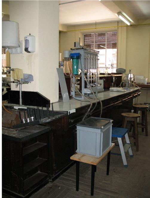
*Photo 8 : Vue générale du perméamètre de laboratoire Eijkelkamp*
