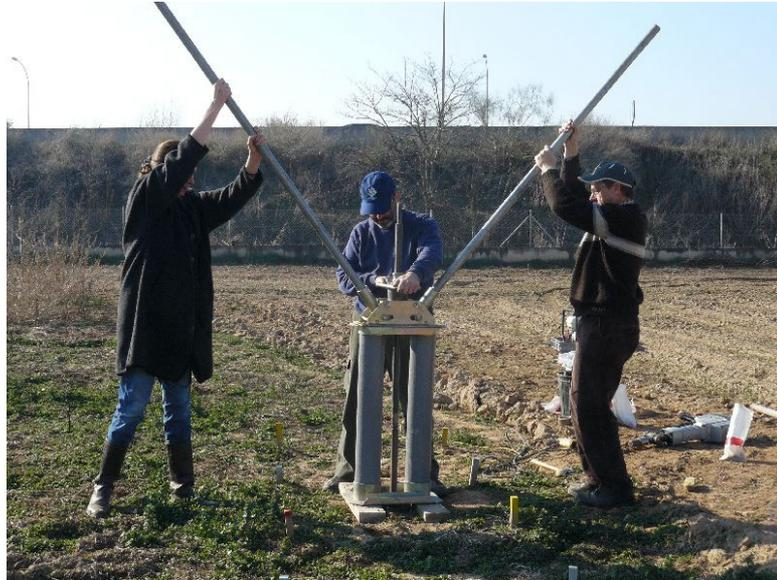
*Photo 7 : Appareillage utilisé pour le prélèvement de la carotte de 2m*
