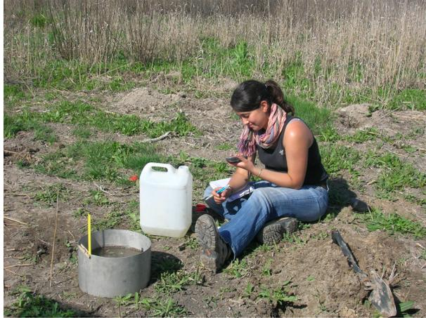
Photo 13: Essais d'infiltration à charge constante
